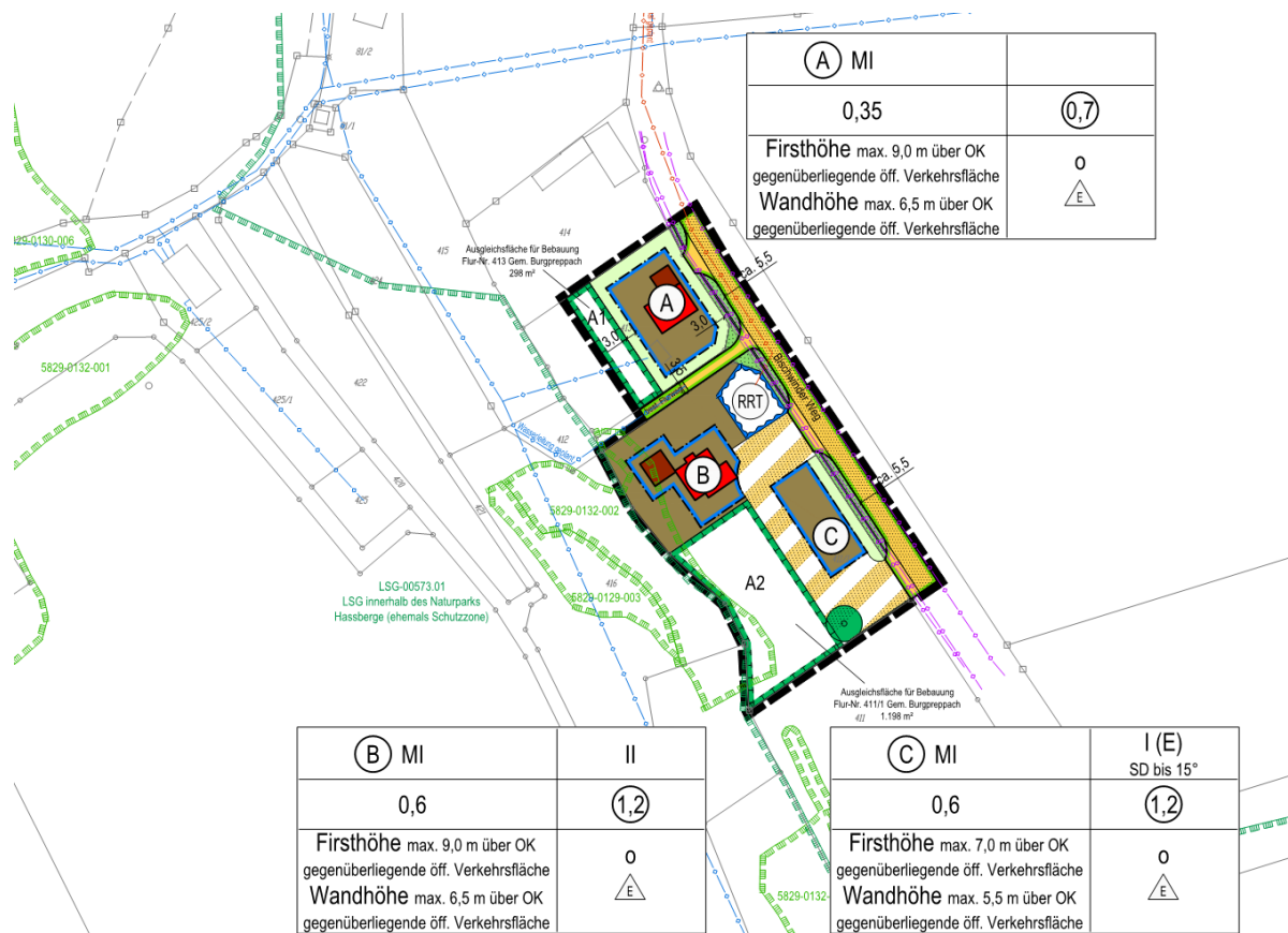
Abb. 6: Planteil mit Nutzungsschablone
